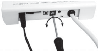
Posicionar el selector rotativo en el nuevo idioma.
